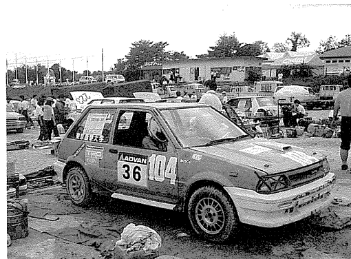
▲ダートトライアル使用車 足まわりはラリータイヤに大容量のショックアブソーバー。場所によってはアンダーガードを装着します
