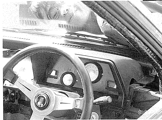
◀競技車輛のコクピット 見易く作ったメーター類。車内を守るロールバーは6P式で万が一の転倒でも安心です
